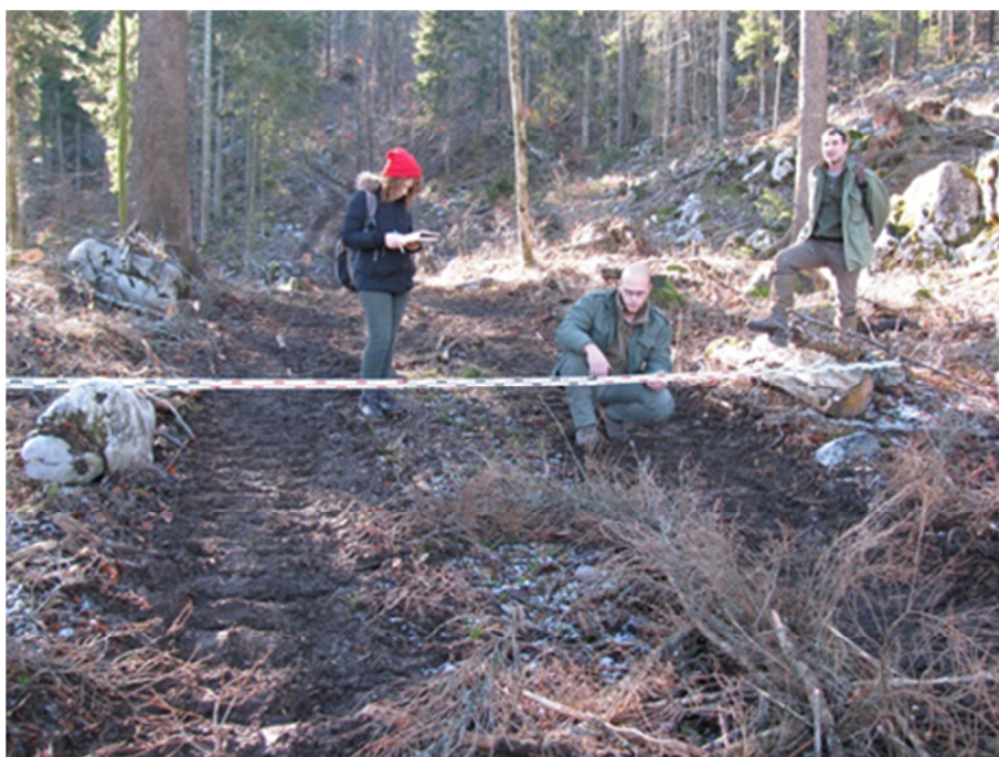
Slika 6. Mjerenja kolotraga nakon prolaska harvestera u šumariji Gerovo
